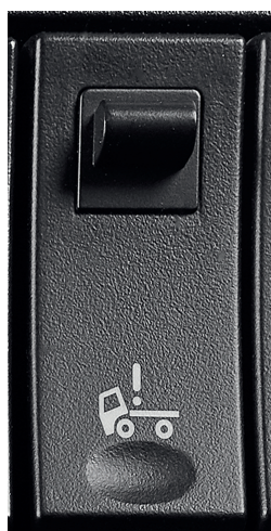
Включение насоса подъема кабины
