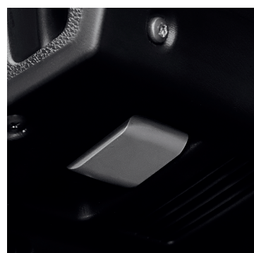
Рычаг открытия капота
